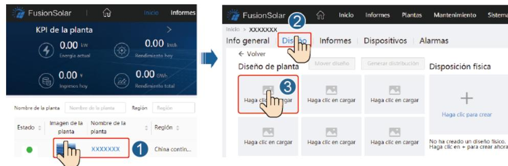
**Paso 2** Inicie sesión en <https://intl.fusionsolar.huawei.com> para acceder a la WebUI del sistema de gestión FusionSolar Smart PV. En la **Inicio**, haga clic en el nombre de la planta para ir a la página de la planta. Seleccione **Diseño**. Seleccione **Generar distribución** y cree la distribución física cuando se le solicite. También puede crear una distribución de ubicación física manualmente.
