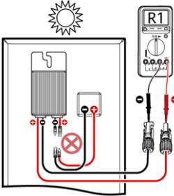
La entrada del optimizador no está conectada:  $1.1 \text{ k}\Omega < R1$
