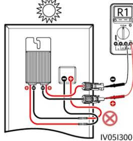
La salida del optimizador está conectada a la salida del módulo FV:  $1.1 \text{ k}\Omega < R1$
