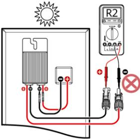
Las sondas están conectadas a la inversa. El valor medido R2 es inferior a la resistencia medida cuando las sondas están conectadas correctamente.
