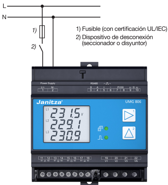
Fig. Conexión de la tensión de alimentación.
