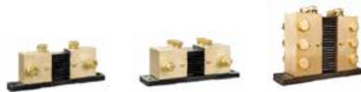
Derivador de 1000A/50mV, 2000A/50mV y 6000A/50mV El circuito impreso de conexión rápida del derivador estándar 500A/50mV también puede montarse en estos derivadores.
